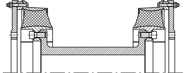
2S–Elemente für größere Wellenverlagerung und Körperschallreduzierung
